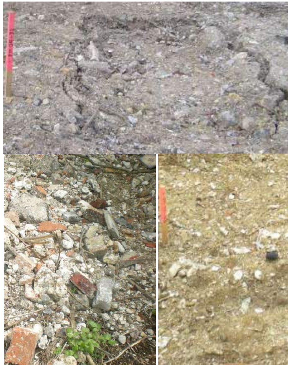
Exemple de l'aspect des remblais
