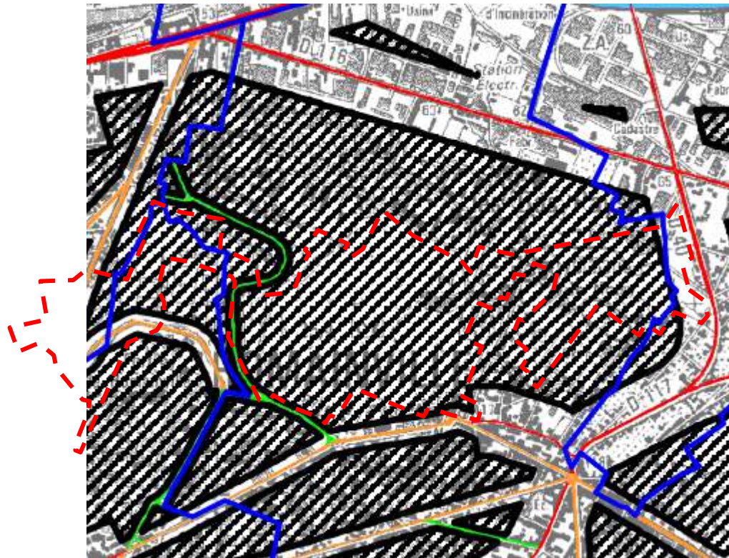
Figure 100: Classement sonore des infrastructures de transport terrestre de Seine Saint-Denis. En bleu les limites des communes, en vert les voies de catégorie 5, en orange de catégorie 4 et en rouge de catégorie 3
