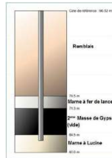
Figure 119: Exemple de profil de pieu au niveau de l'appui N°3 et photographie de pieux traversant – source :EGIS
