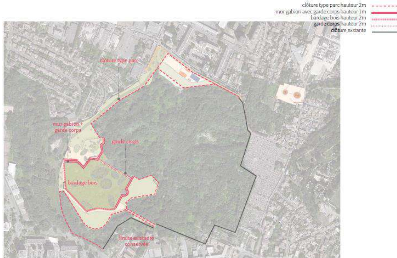
Figure 135: Clôtures du Parc - source: ÎLEX
