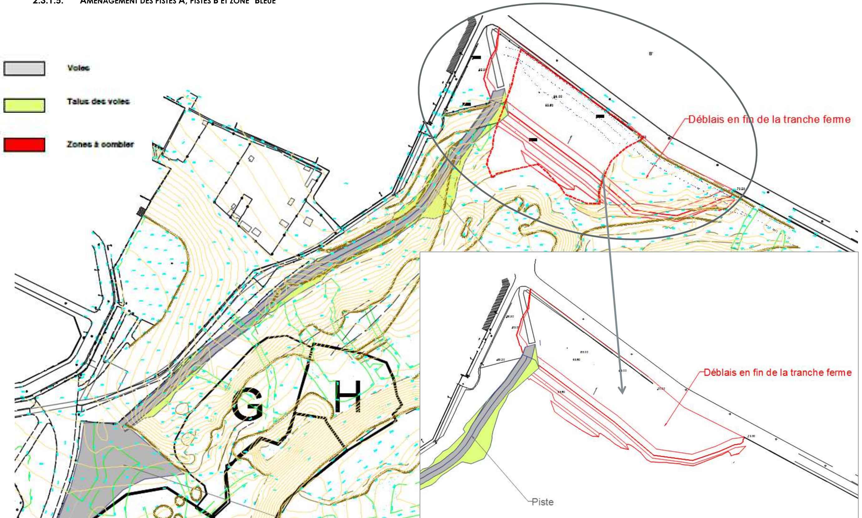
Figure 116: Terrassements des pistes et remblaiement - piste A
