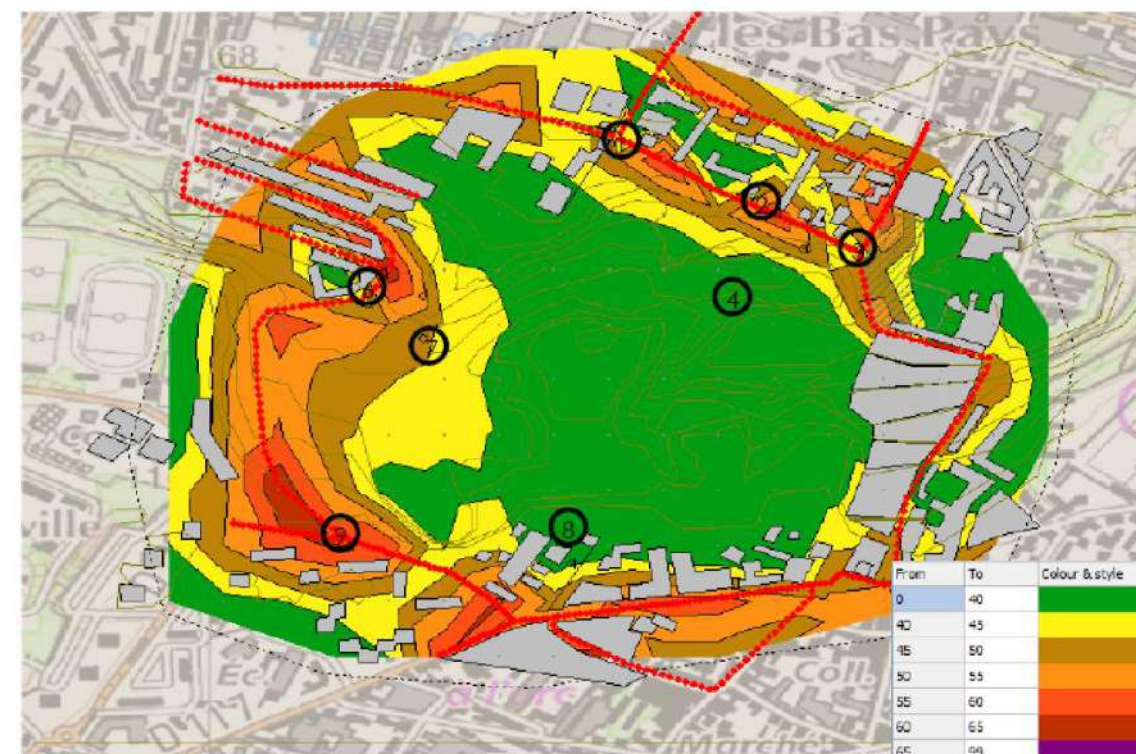
Figure 198 : Cartographie initiale des niveaux sonores évaluée avec Predictor – jour – source : CAP HORN
