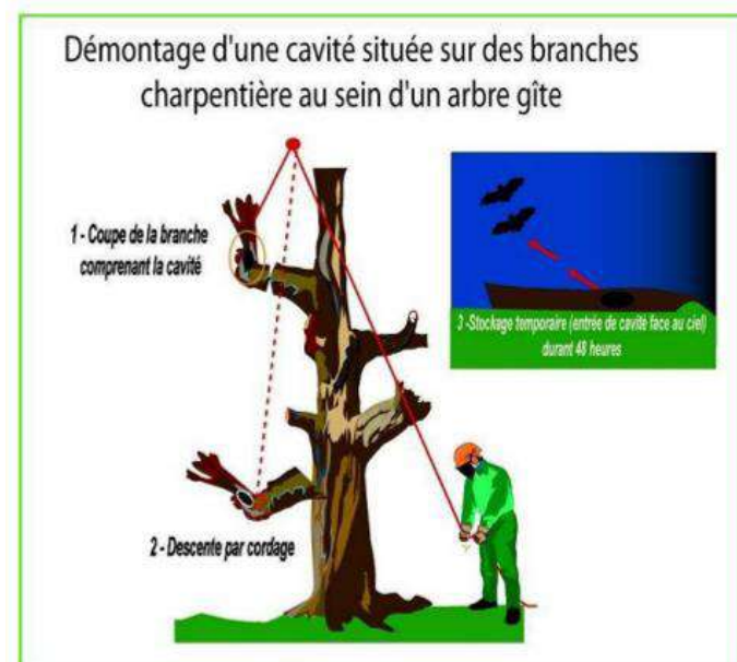
Figure 215 : Schéma présentant les précautions à prendre en cas d'abattage par démontage manuel assisté – source : Biotope
