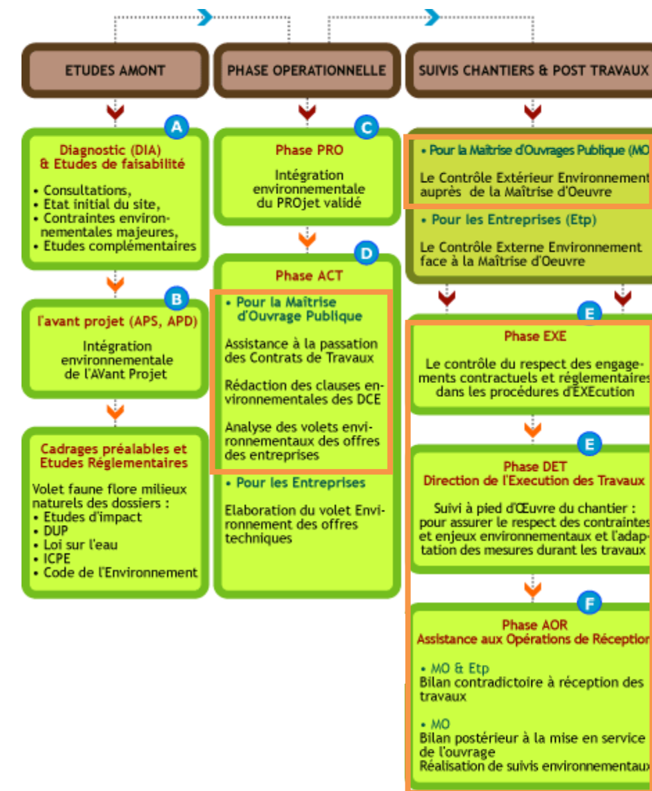
Figure 264: Intervention de l'ingénieur-écologue dans le cadre d'une mission de suivi écologique de chantier (© Biotope)
